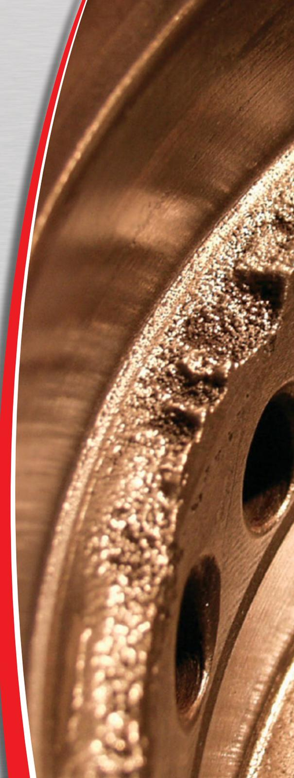
**Phase 1: Behebung der Kavitationsschäden**
